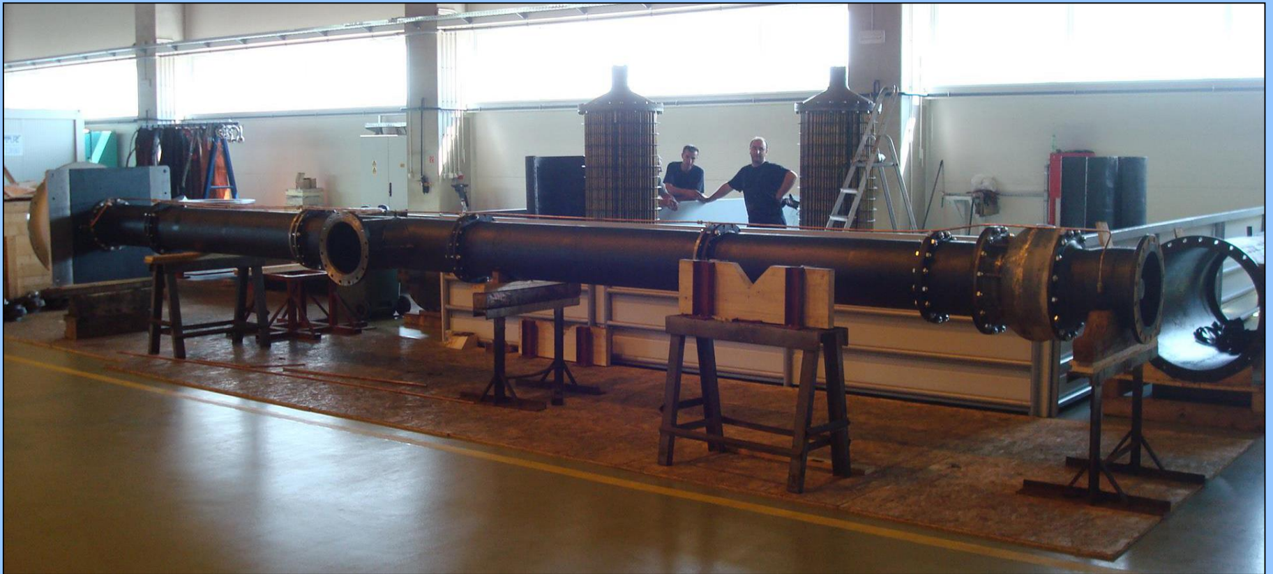
Uronjene poluaksijalne pumpe velikih protoka
