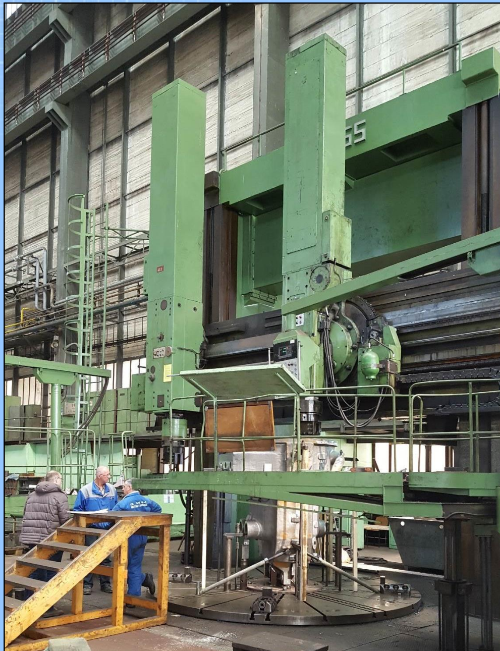
Kućište turbnie 3,6MWe na završnoj obradi
