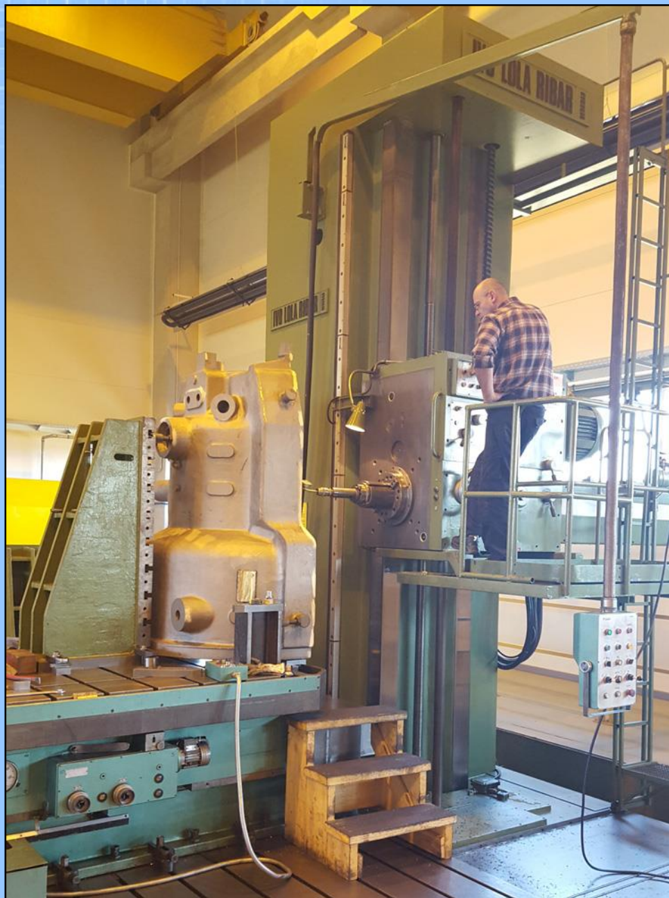
Obrada donjeg kućišta turbine na borverku u TTK – 15.02.2017.
