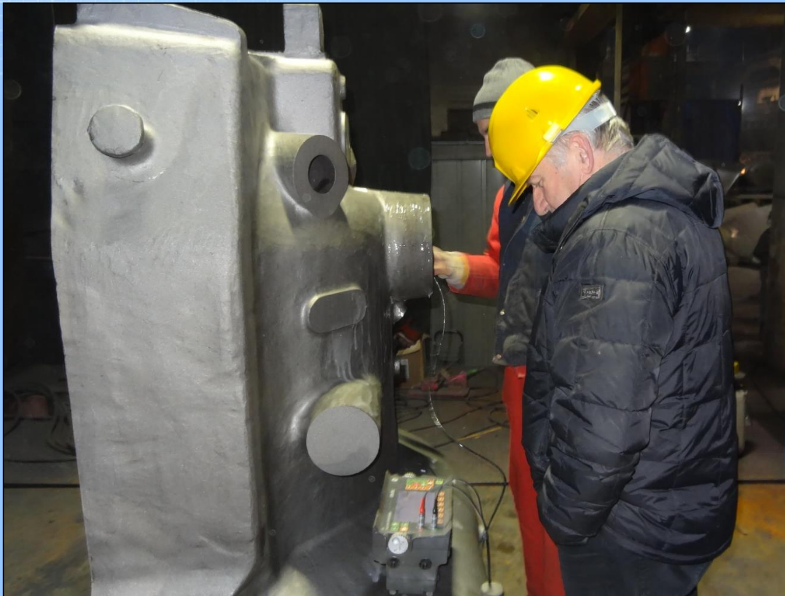
Ultrazvučna kontrola odljevka glavnog kućišta turbine 3,6 MWe – 09.02.2017.
