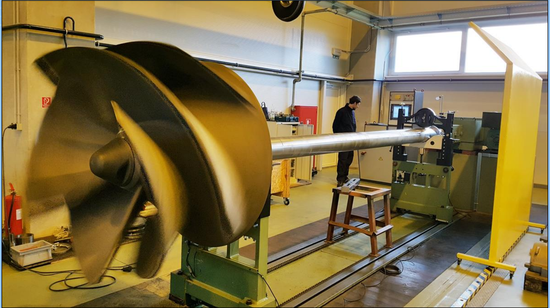
Balansiranje rotora poluaksijalne rashladne pumpe iz NE Krško, 2016. godine
