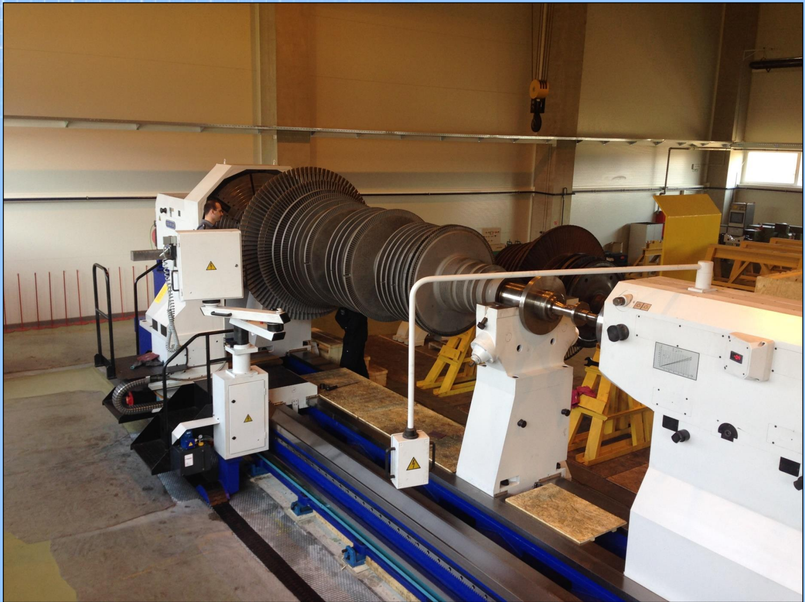
Rotor parne turbine 19 MW na novom tokarskom stroju Poreba CNC NOSIVOST - 25.000 kg, RAZMAK ŠILJAKA - 8.000 mm, VISINA ŠILJAKA - 1.500 mm , MAX. PROMJER TOKARENJA - 3.000 mm
