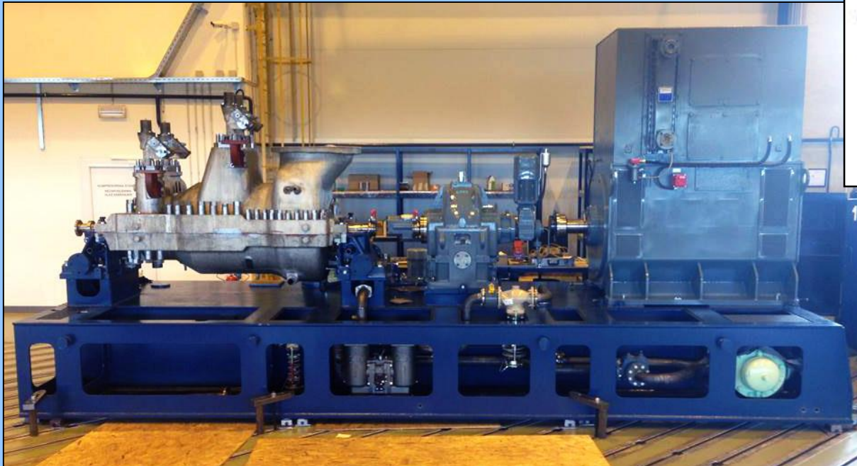
Višestupanjska parna turbina u kogeneraciji na biomasu snage 1,2MWel + 4MWt
