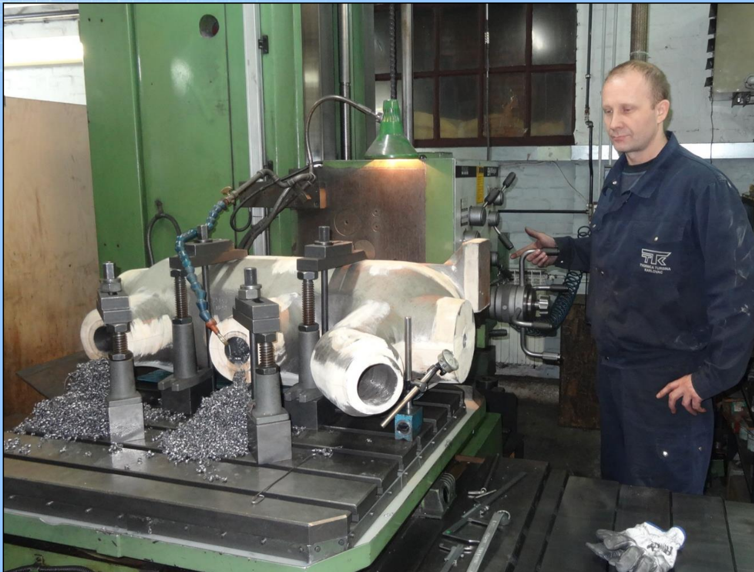
Obrada ventilskog kućišta 3,6MWe Đakovo – 09.02.2017.
