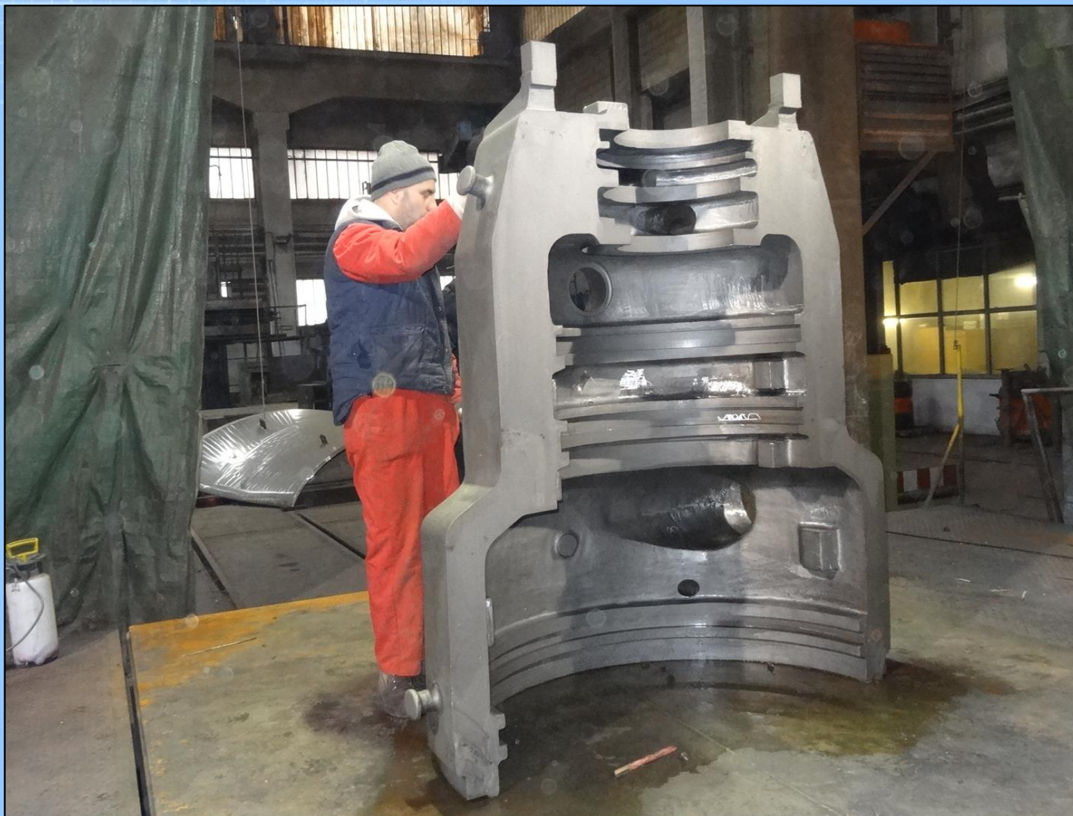
Ultrazvučna kontrola odljevka glavnog kućišta turbine 3,6 MWe – 09.02.2017.
