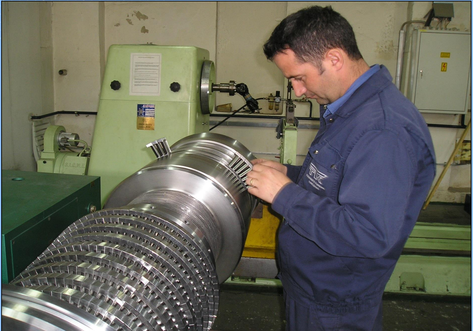
Umetanje lopatica na osovinu rotora u tvonici TTK, Karlovac
