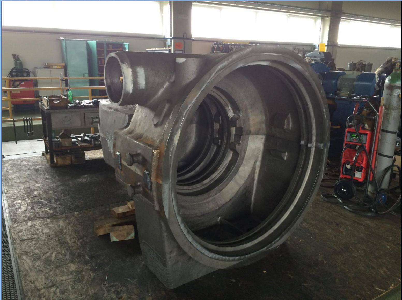
Kućište turbnie 3,6MWe pripremljeno za završnu obradu
